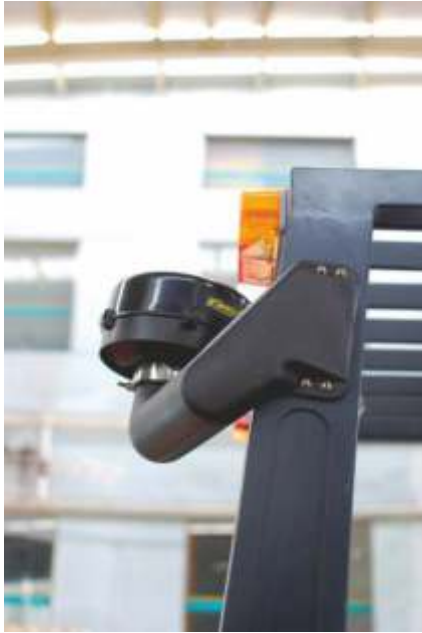
Двойной воздушный фильтр циклонного типа
