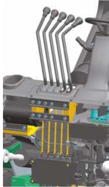
Возможность установки 5-ти секционного гидрораспределителя
