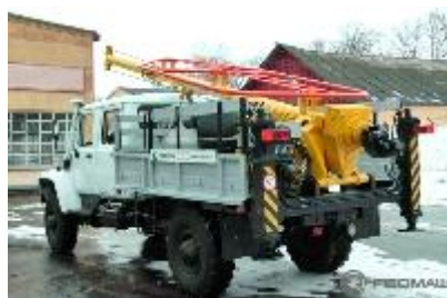
БКМ-360 на шасси ГАЗ-33081. Транспортное положение
